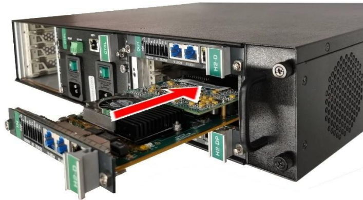
図7：MTX3-16-M への入出力カードの取り付け
