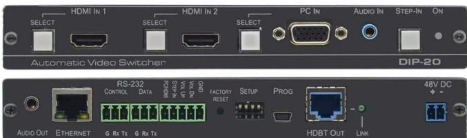
入力：2 HDMI、1PC映像 (HD15ピン)、1 ステレオ音声 (φ3.5mmミニジャック)
